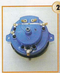
2 Así es como está construida la parte trasera del velocímetro.
