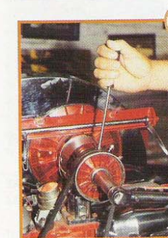
9 Tuerca de la polea del cigüeñal 30 mm torqueada a 36 Ft.-Lbs.
