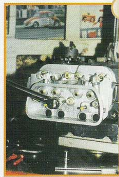
3 Tuercas del carter 13 mm torqueadas a 14 Ft.-Lbs.
