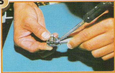
Existen algunas mangueras que aunque son un poco gruesas, con la ayuda de un desarmador plano entran perfectamente en la abrazadera.
