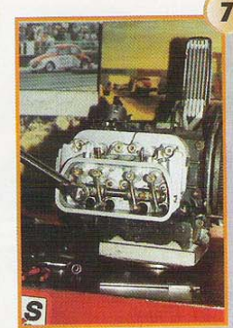
7 Tuercas del Balancín 13 mm torqueadas a 18 Ft.-Lbs.
