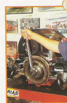
6 Tuerca hueca 36 mm torqueada a 240 Ft.-Lbs.
