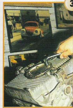
3 Tuercas del carter 13 mm torqueadas a 14 Ft.-Lbs.
