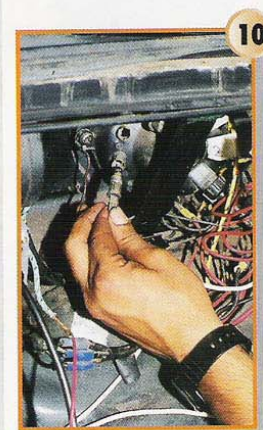
10 Un poco más abajo, encontrarás otra entrada, es del foco que señala el encendido de la luz de alta, sácalo.
